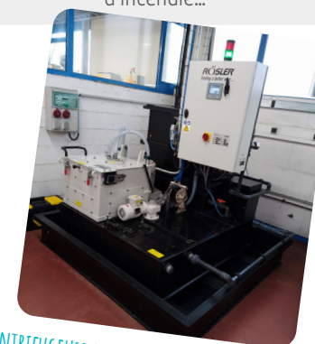
CENTRIFUGEUSE POUR LA RÉUTILISATION DES EAUX DE TRIBOFINITION - SUBVENTION DE 70% PAR L'AGENCE DE L'EAU
